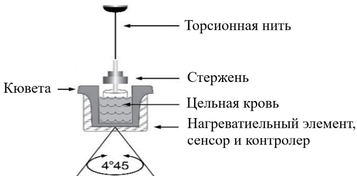
Рисунок 2 –Принцип проведения тромбоэластографии на приборе TEG® 500
